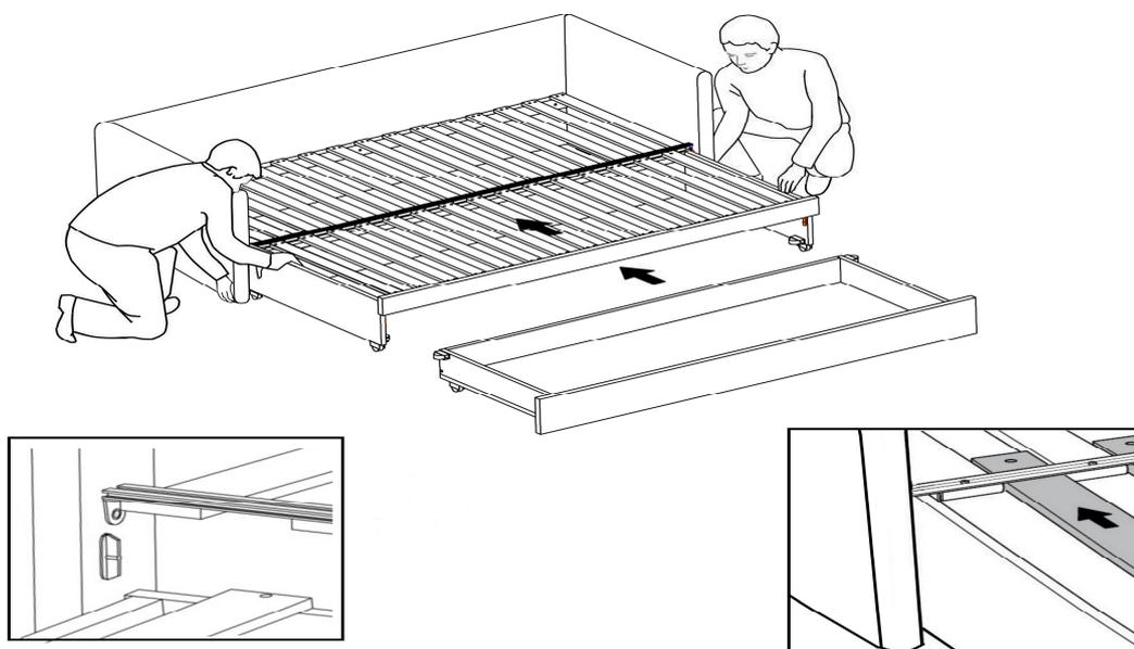
7. Выкатная часть. Схема сборки №1
