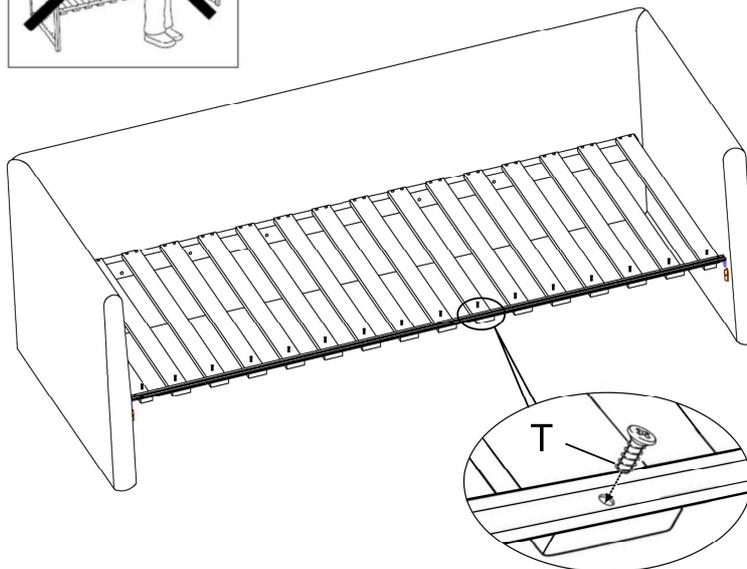
5. Корпус. Схема сборки №5
