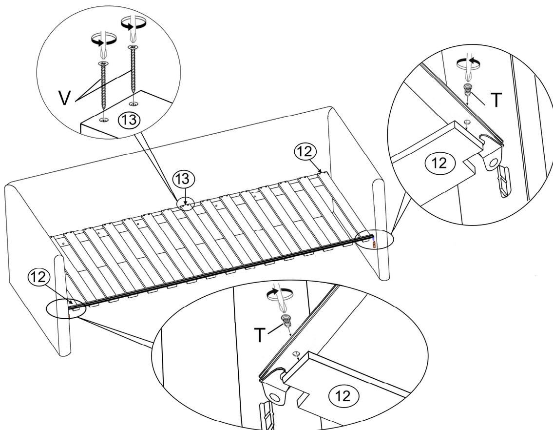
6. Корпус. Схема сборки №6
