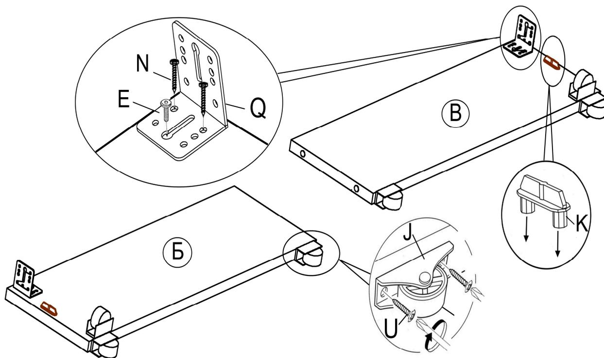
9. Выкатная часть. Схема сборки №3
