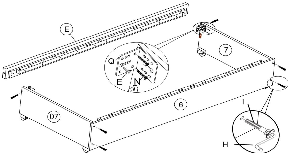
10. Выкатная часть. Схема сборки №4
