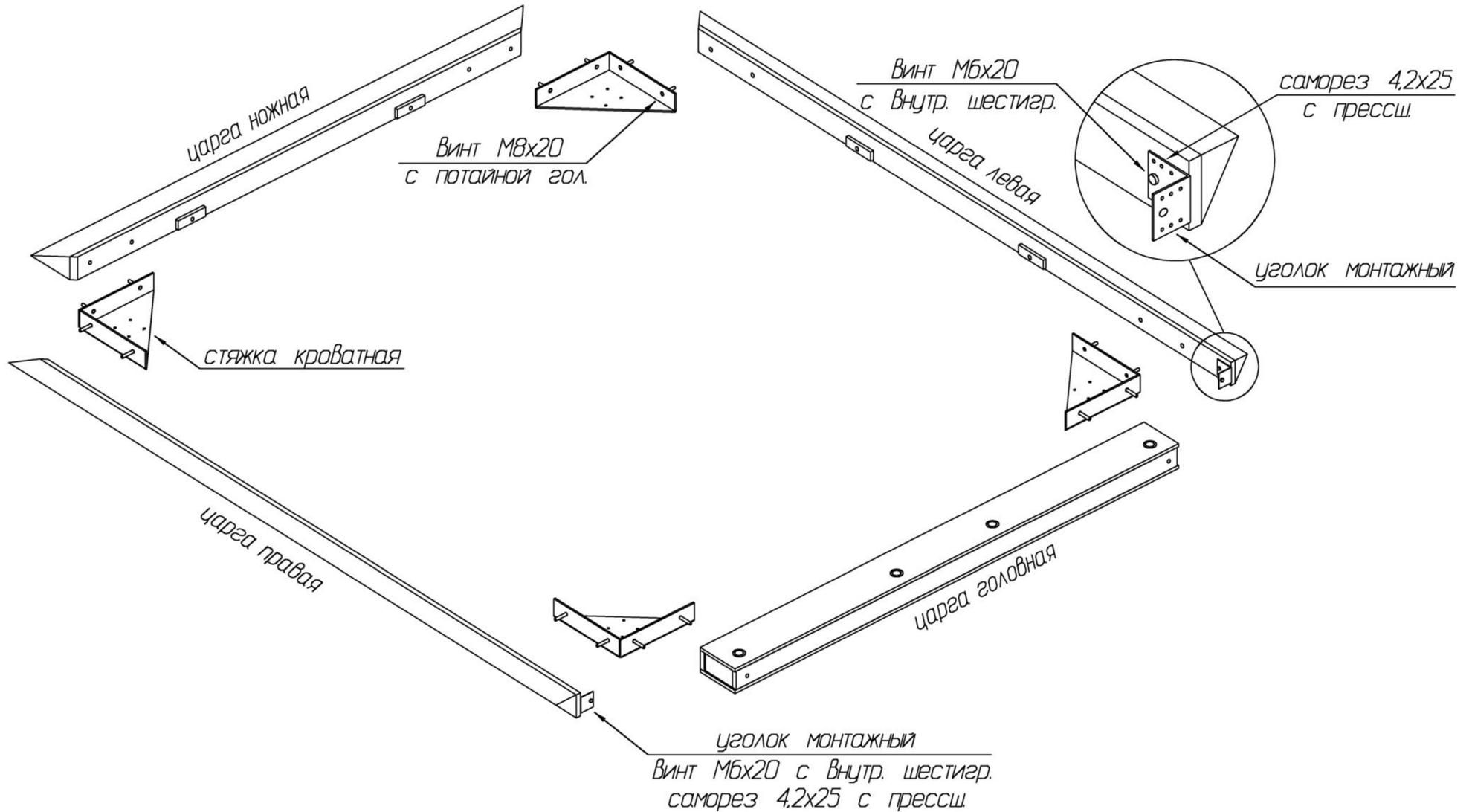
3. Закрепить головную царгу к монтажным уголкам с помощью винтов М6х20 с внутр. шестигр. и саморезов 4,2х25 с прессшайбой.
