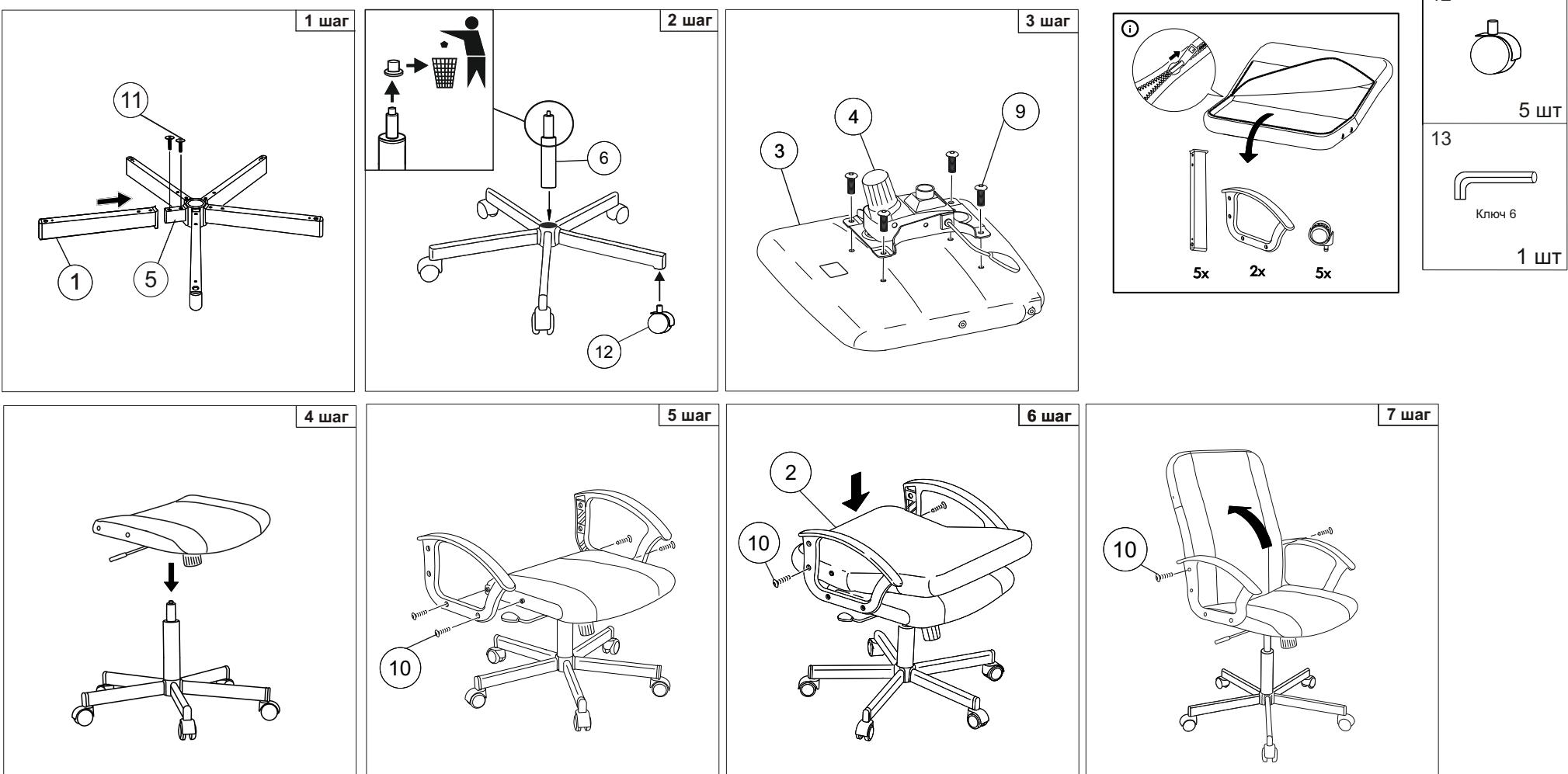
Примечание: Шаг 2. Снять защитный колпачок с газлифта, в случае его наличия. Шаг 5-7: Вставить и закрутить винты поочерёдно, не затягивая их до конца. После выполнения шага 7 закрутить все винты до полной фиксации.
