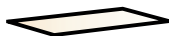
Полка в шкаф L400 → | 7 | 1 | ↑ 364|264|16 Полка в шкаф L500 → | 7 | 1 | ↑ 464|264|16 Полка в шкаф L600 → | 7 | 1 | ↑ 564|264|16 Полка в шкаф L800 → | 7 | 1 | ↑ 764|264|16
