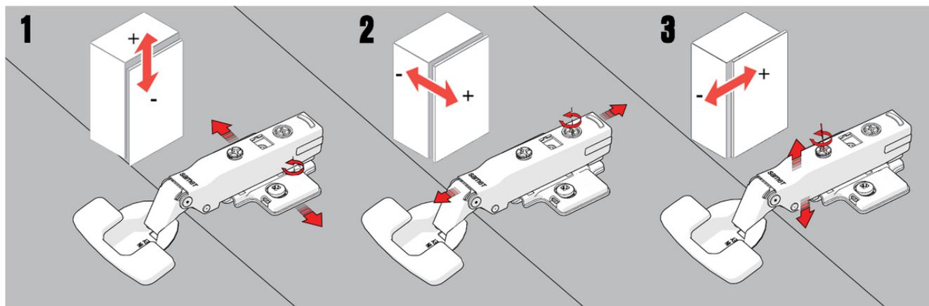
Для корректной работы системы PUSH необходим зазор между фасадом и корпусом не менее 4мм.
