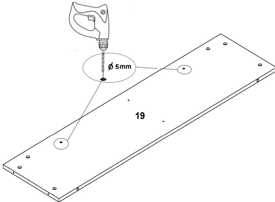
Для крепления серванта к стене досверлить отверстия d5/d9 насквозь.
