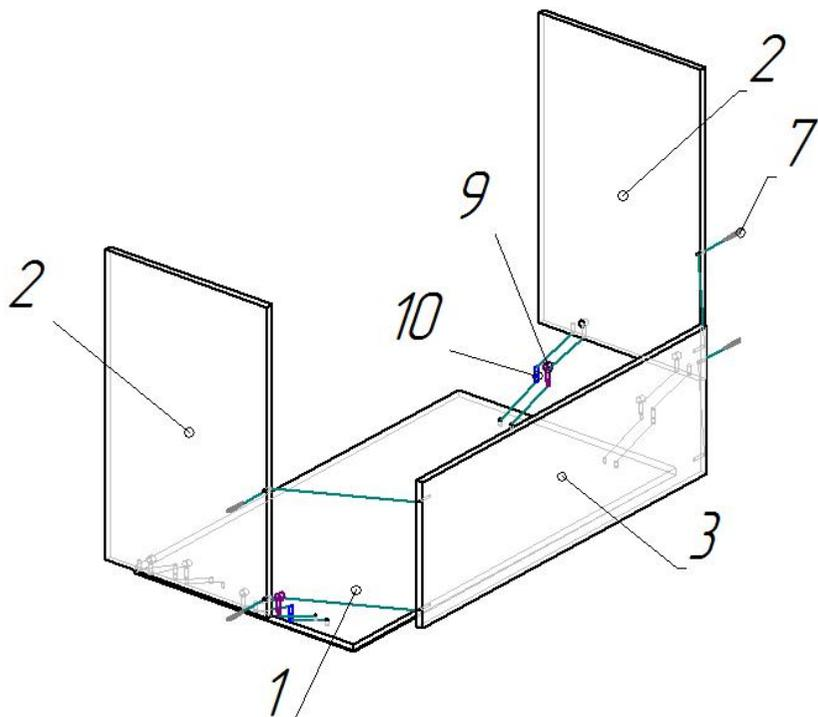
Рисунок 1 – Схема сборки стола
