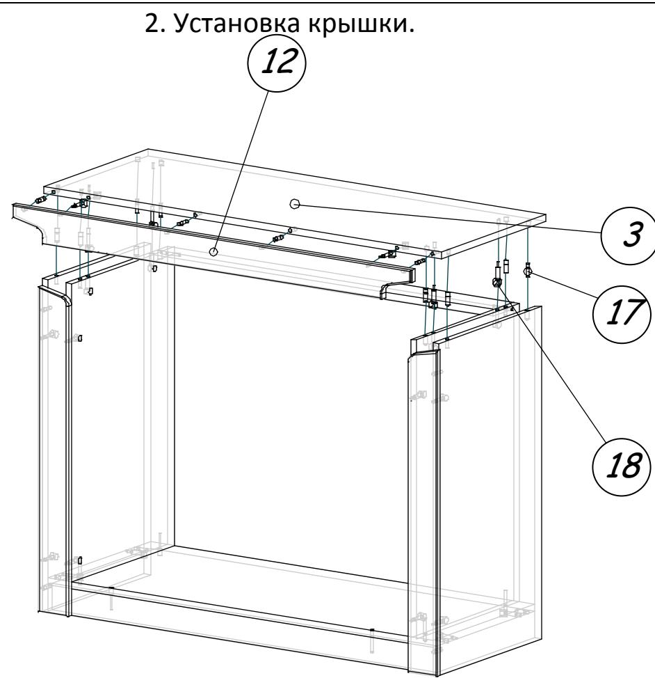
\*Закрепите крышку 3 к собранной конструкции
