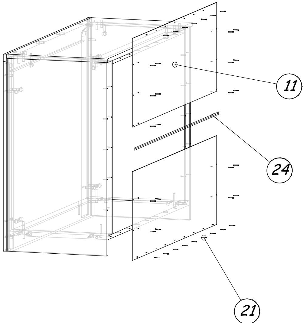
\* Закрепите задние стенки 11 к конструкции гвоздями 21
