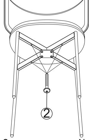
Закрутить винты №2 во все отверстия, затем затянуть, затянуть винты №3
