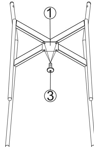
Установить пластину №1, закрутить винты №3, но не затягивать
