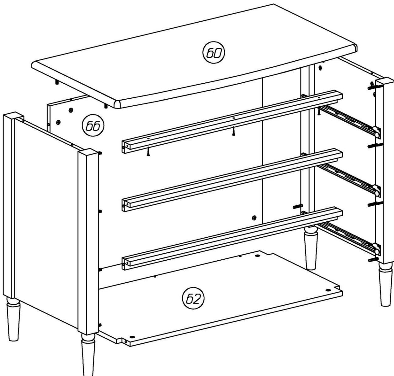
5. На деталях **62, 64, 66** в отверстия диаметром 15мм вставить эксцентрики Rastex 15/16. Стрелка на эксцентрике должна быть повернута в сторону кромки.
