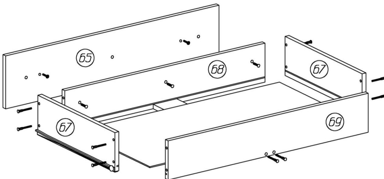
12. Винтами М4х20 закрепить на фасадной стенке ручки. Закрепить фасадную стенку на ящике, вворачивая винты М6х25 через переднюю стенку ящика в муфты, установленные в фасаде.
