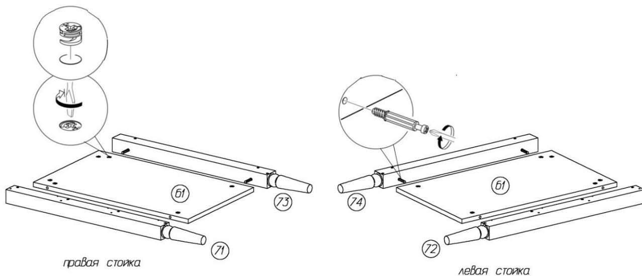
2. На собранных стойках закрепить роликовые направляющие: сначала к задней стойке шурупами 6,3x10,5, затем к передней стойке шурупами 3,5x13, выбрав отверстия, совпадающие с направляющей;
