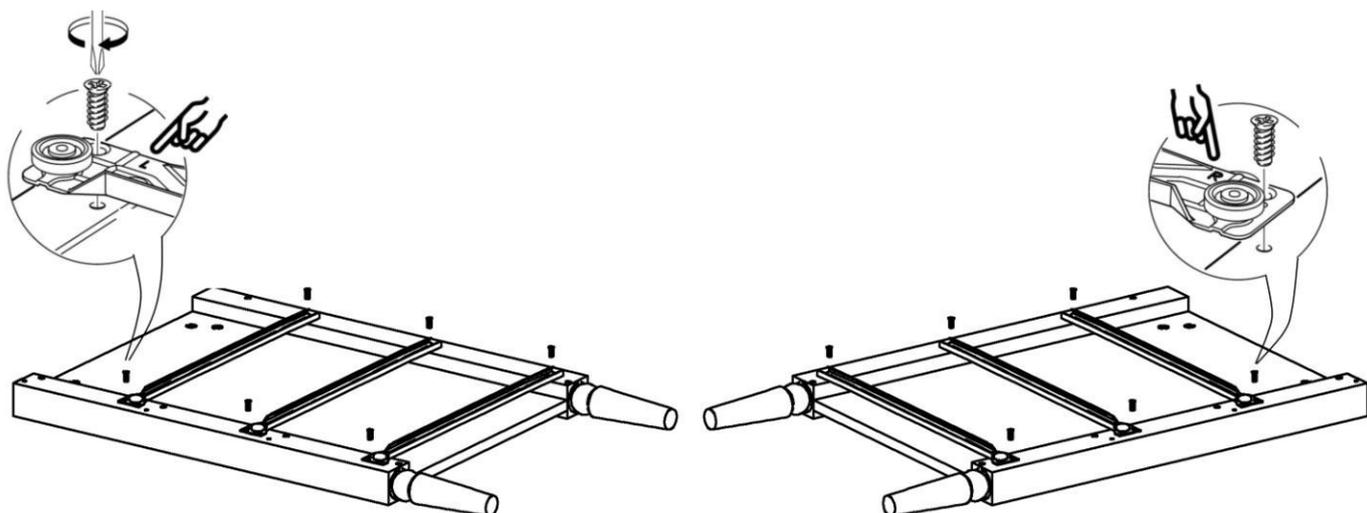
3. В отверстия диаметром 6 мм на передних ножках вставить шканты, в отверстия диаметром 5 мм на задних и передних ножках вернуть дюбели стяжки.
