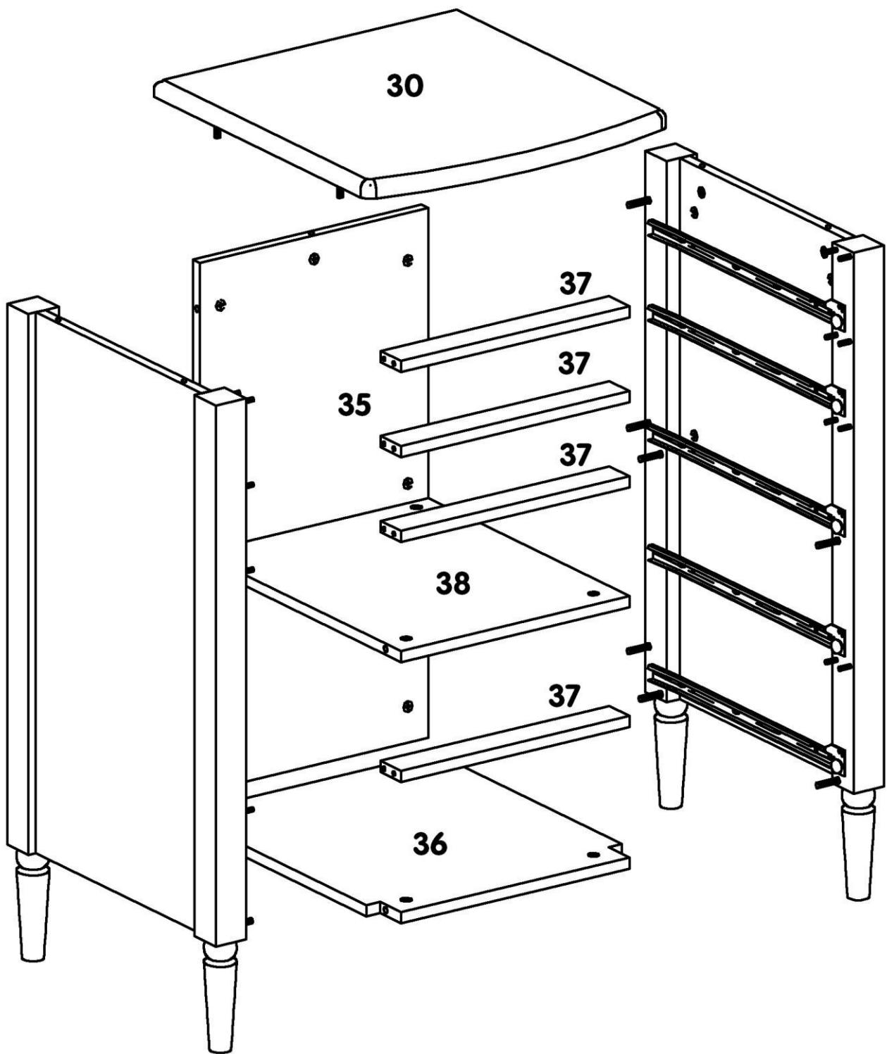
4. На деталях 35, 36, 37 в отверстия диаметром 15мм вставить эксцентрики Rastex 15/16. Стрелка на эксцентрике должна быть повернута в сторону кромки.
