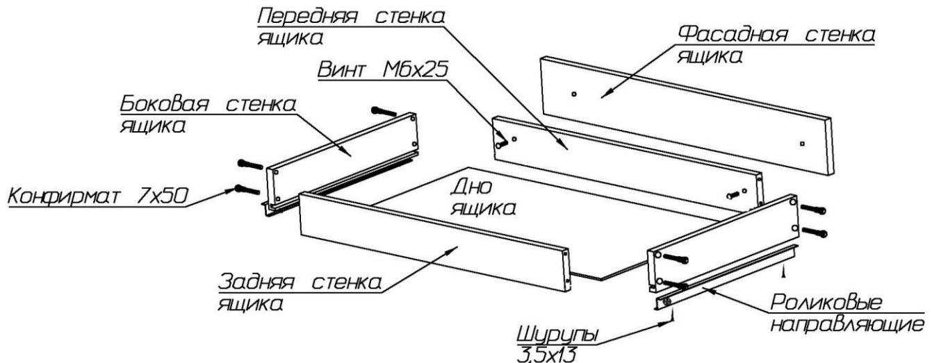
11. Винтами M4x20 закрепить на фасадной стенке ручки. Закрепить фасадную стенку на ящике, вворачивая винты M6x25 через переднюю стенку ящика в муфты, установленные в фасаде.
