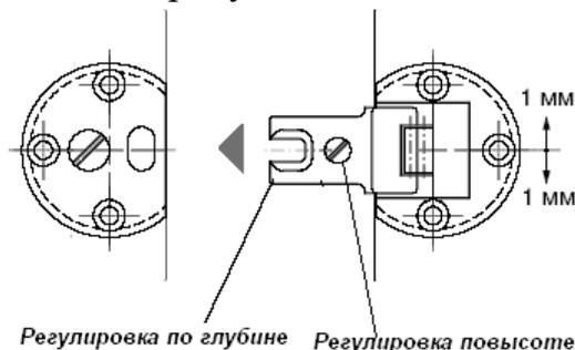
Отрегулировать дверь по высоте так, чтобы ролик защелки входил в ответную планку.
