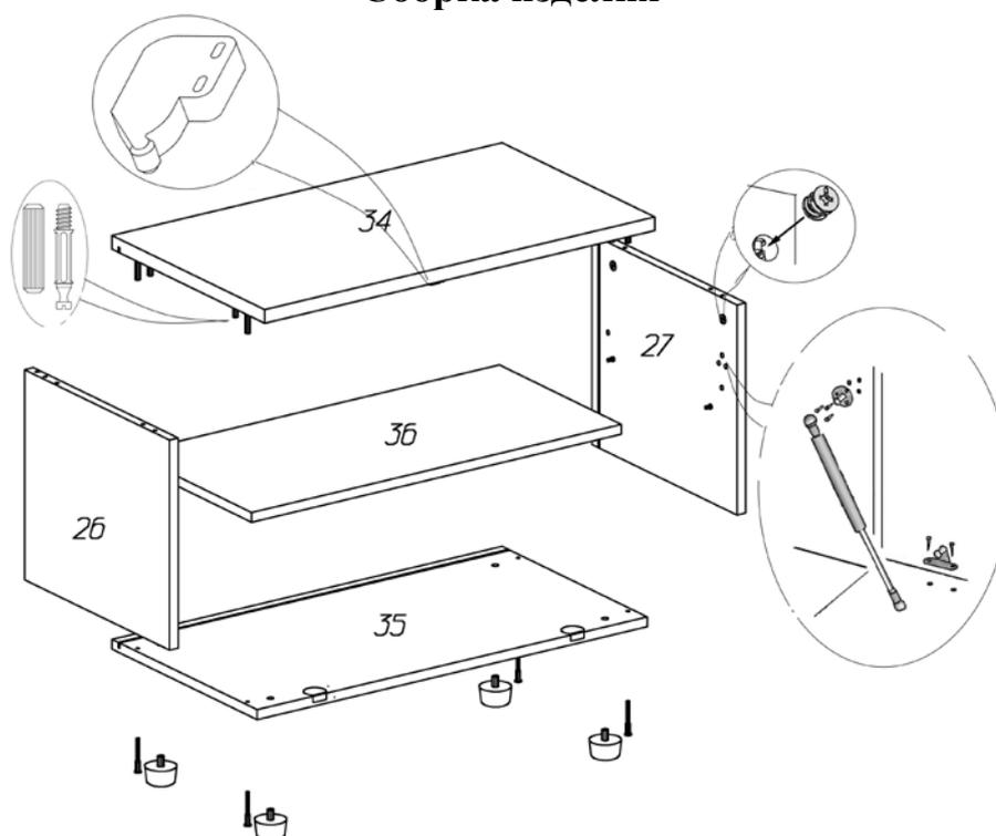
При блокировании с другими изделиями из серии MODUS рекомендуется использовать межсекционные стяжки. Для этого необходимо на стенке вертикальной со стороны блокируемого изделия досверлить насквозь отверстия диаметром 5 мм (верхний ряд)
