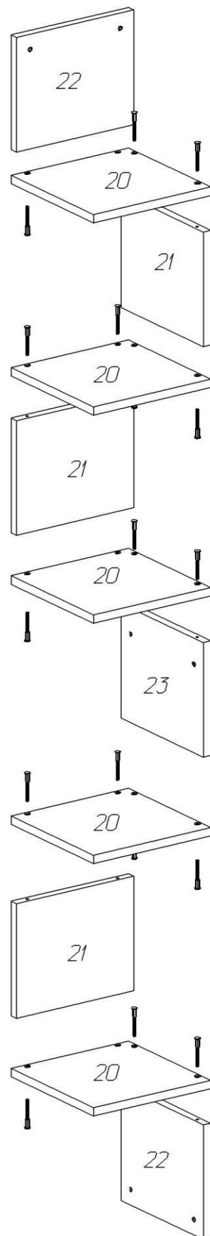
Стенка **23** отличается от стенки **21** наличием отверстий для крепления к стене. Устанавливается в средней части полки.
