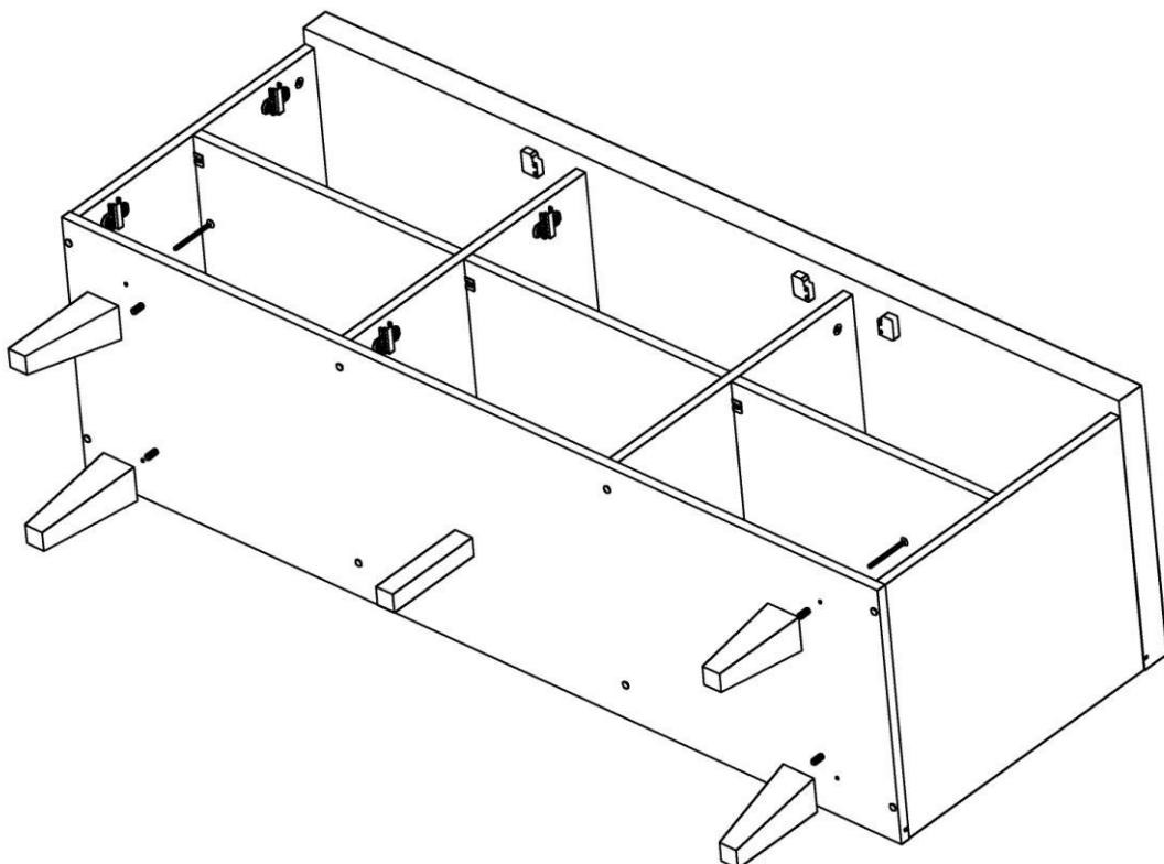
13. Для защиты от опрокидывания тумбу рекомендуется закрепить к стене. Для чего через отверстия в задней стенке сделать отметки на стене. Отодвинуть изделие, просверлить в стене отверстия диаметром 6мм, вбить в стену пластиковые дюбели. Поставить комод на место и через отверстия в задней стенке закрепить изделие шурупами 4х60, вворачивая их в дюбели. Отверстия в задней стенке закрыть самоклеящимися заглушками.
