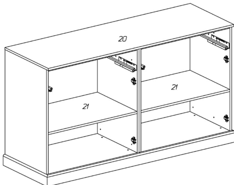
Регулировка высоты опор осуществляется через отверстия в нижнем щите любым из инструментов: отвертка шлиц/крест или шестигранный ключ 6мм.
