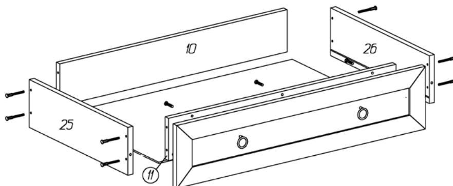
Привернуть боковые стенки ящика к передней и задней стенкам при помощи конфирматов 7x50. Пазы боковых стенок должны быть ориентированы внутрь ящика.
