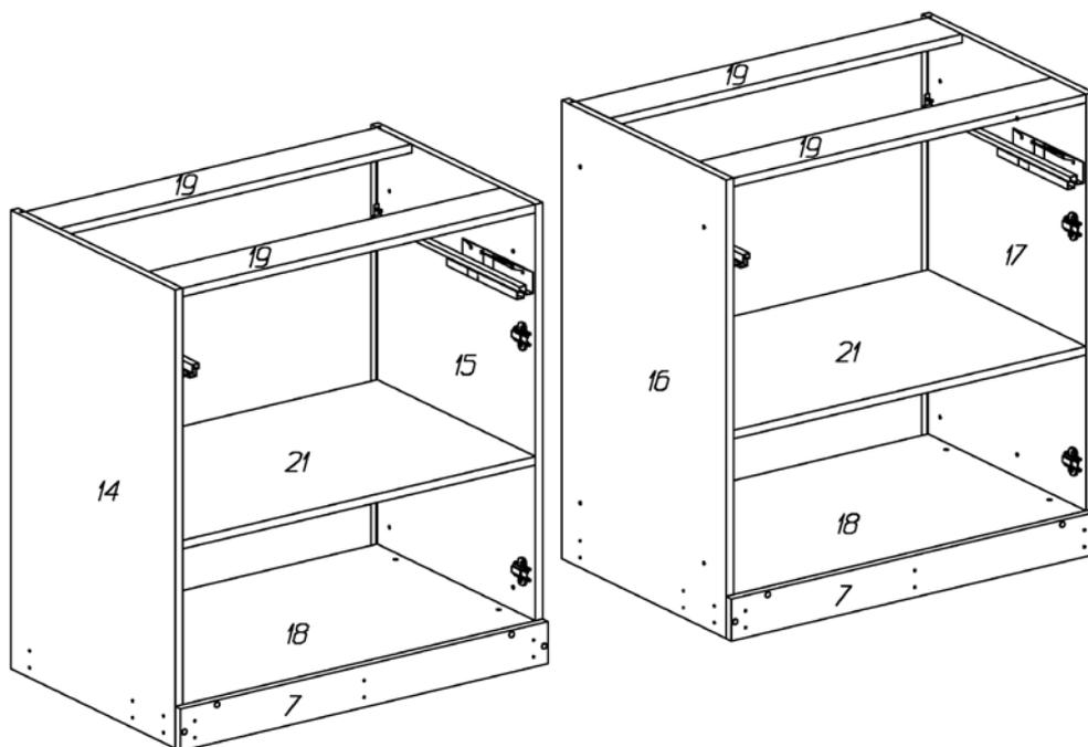
Если к тумбе будет примыкать стеллаж, то на стенке вертикальной со стороны примыкания (**14 или 17**) примыкания для межсекционной стяжки необходимо досверлить насквозь отверстия диаметром 5 мм и зенковать их для винта с потайной головкой.
