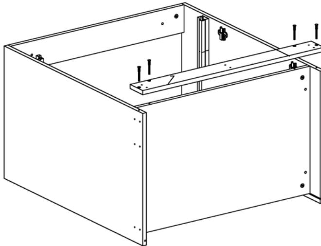
5. Соединить два корпуса - смежные стенки 15 и 16:
