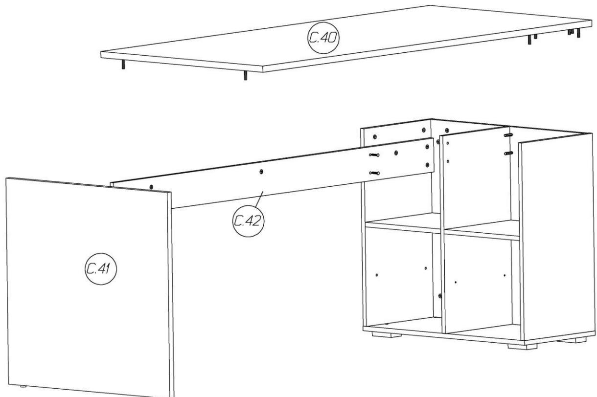
9. На крышке **C40** в установленные муфты ввернуть дюбели DU 644 (с метрической резьбой) эксцентриковых стяжек, в соседние отверстия вставить шканты.
