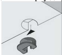
На карнизе в отверстия диаметром 5мм на профилях ввернуть дюбели DU 232.
