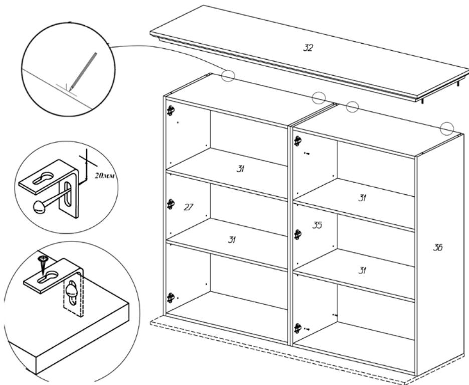
В отверстия на полках **31** вставить врезные полкодержатели VB 135. Установить полки, надев их сверху до упора на дюбели, ввернутые в боковые стенки.
