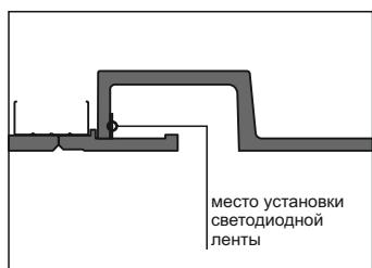
Подключите светодиодную ленту к источнику питания и наклейте её на техническую алюминиевую полосу, которая установлена внутри светильника.
