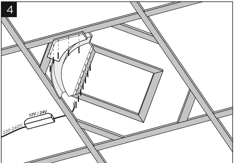
Затем закрепите 1/8 основания светильника к каркасу потолка саморезами (входят в комплект светильника)
