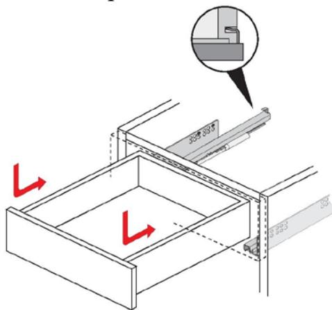
13.Отрегулировать положение фасадов по длине тумбы - ослабить винты крепления фасада, перемещая фасадные стенки выставить равные зазоры между ними, затянуть винты.
