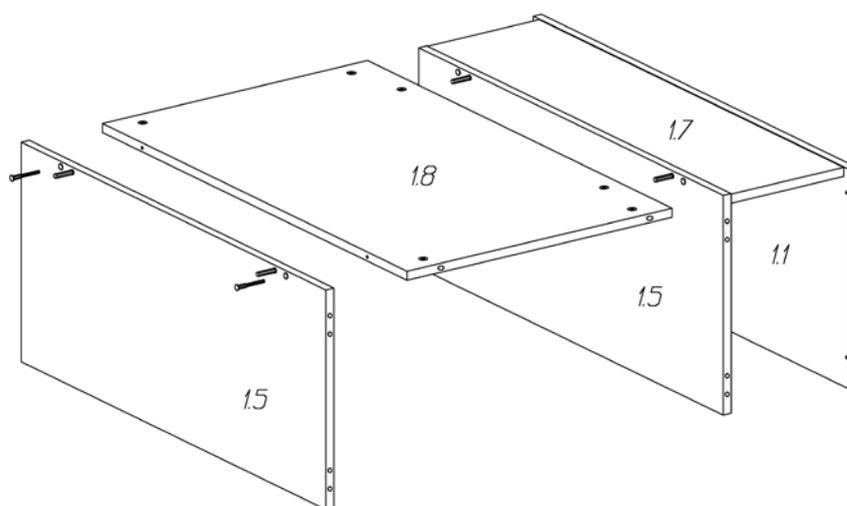
9. Полученную конструкцию и стенку горизонтальную **1.6** установить между стенок вертикальных **1.6**, **1.4** так, чтобы дюбели стяжек и шканты вошли в соответствующие им отверстия. Затянуть эксцентрики, повернув их на 180 градусов. Нижний щит **1.1** закрепить к стенкам вертикальным конфирматами 7x50.
