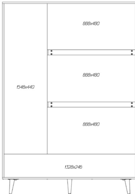
16. Собранные корпуса проверить на прямоугольность, сравнивая диагонали (их длины должны быть равны). Прямоугольное положение корпуса зафиксировать с помощью мебельных уголков с шурупами. К планкам задним 3.4 задние стенки крепить саморезами 3,5x16. В местах стыка задние стенки закрепить скрепками с шурупами 3x20мм впотай.
