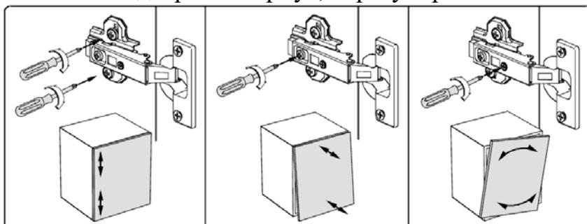
Верхние фасады открываются от нажатия. Для корректной работы системы PUSH необходимо создать зазор между дверью и корпусом не менее 3мм.
