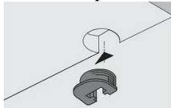
7. На стенке задней **5.28** в отверстия диаметром 15 мм установить эксцентрики, таким образом, чтобы стрелка была повернута в сторону кромки.
