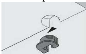
7. Установить верхний щит 5.2 так, чтобы дюбели стяжек и шканты вошли в соответствующие им отверстия на деталях 5.3, 5.4, 5.5, 5.6. Затянуть эксцентрики.
