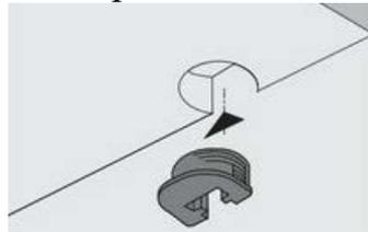
5. Установить верхний щит **5.18** так, чтобы дюбели стяжек и шканты вошли в соответствующие им отверстия на деталях **5.4, 5.6, 5.19**. Затянуть эксцентрики.
