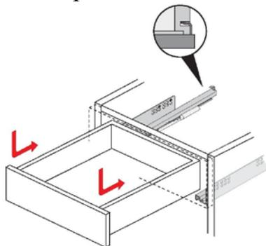
17. Отрегулировать положение фасадов по длине изделия - ослабить винты крепления фасада, перемещая фасадные стенки выставить равные зазоры между ними, затянуть винты.
