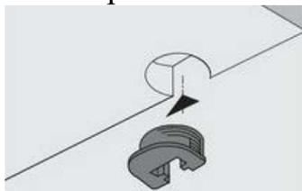
5. Установить верхний щит **5.32** так, чтобы дюбели стяжек и шканты вошли в соответствующие им отверстия на деталях **5.3, 5.25, 5.30**. Затянуть эксцентрики.
