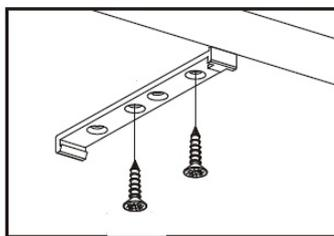
4. На верхнем щите **1.2** в отверстия диаметром 5мм ввернуть дюбели DU 232, в отверстия диаметром 8 мм вставить шканты.
