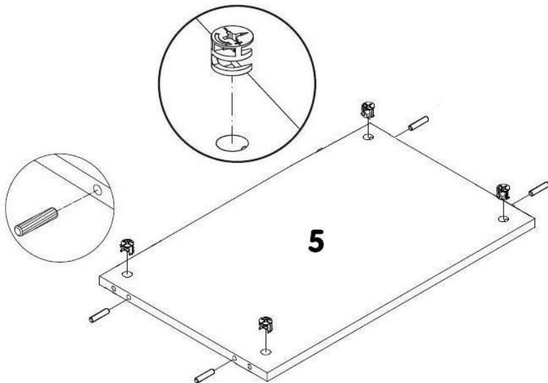
Установить стенку горизонтальную **5** и стенку заднюю **7** между стенками вертикальными **3** и **4** так, чтобы дюбели стяжек и шканты вошли в предназначенные для них отверстия. Затянуть эксцентрики, повернув их на 180 градусов. На стенке задней два отверстия с зенковкой должны располагаться вверху.
