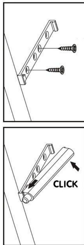
На щитовых дверях с помощью шурупов 3,5x13мм закрепить петли Slide-On.
