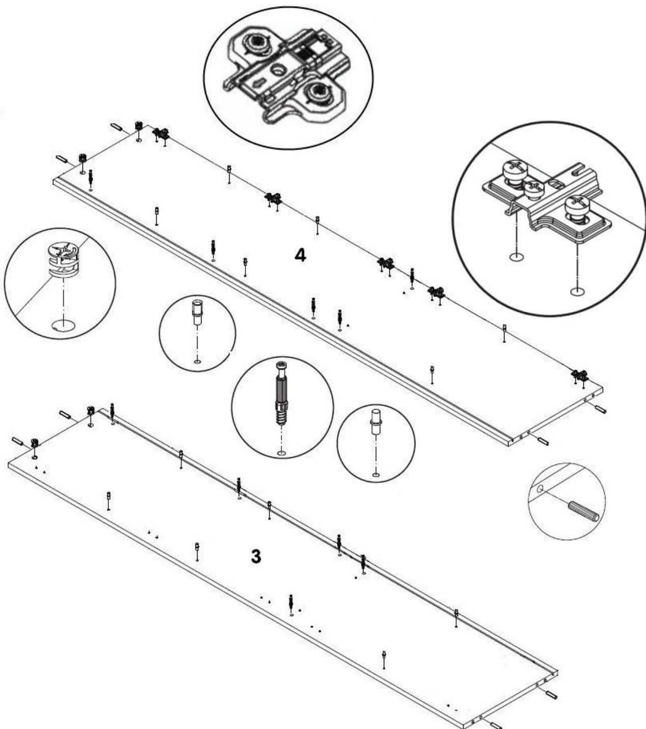
На верхнем щите **1** в установленные муфты эксцентриковых стяжек ввернуть дюбели.
