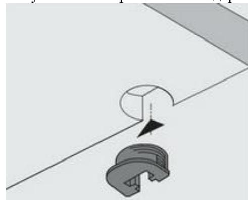
9. Планку **20** установить между стенками вертикальными **16, 18** так, чтобы дюбели стяжек вошли в соответствующие им отверстия. Затянуть эксцентрики, повернув их на 180 градусов. Эксцентрики на планке должны быть развернуты назад.
