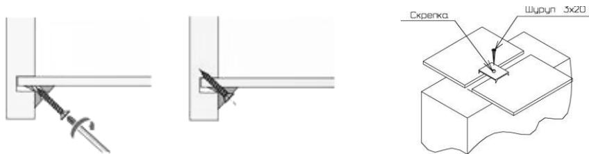
13. На нижнем щите **14** закрепить ножки. В глухие отверстия на нижней стороне щита вставить шканты, посадить на них ножки. Закрепить ножки конфирматами 7x70 через сквозные отверстия в щите. Наклеить на ножки фетровые под пятники.
