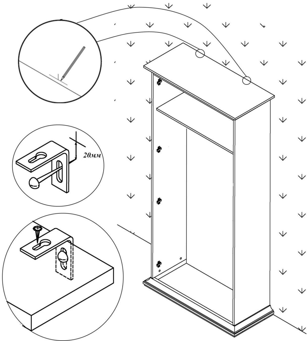
**(i)** Так как материалы стен различаются, шурупы для фиксации на стене не прилагаются. Для выбора подходящих крепёжных средств обратитесь в местный специализированный магазин.
