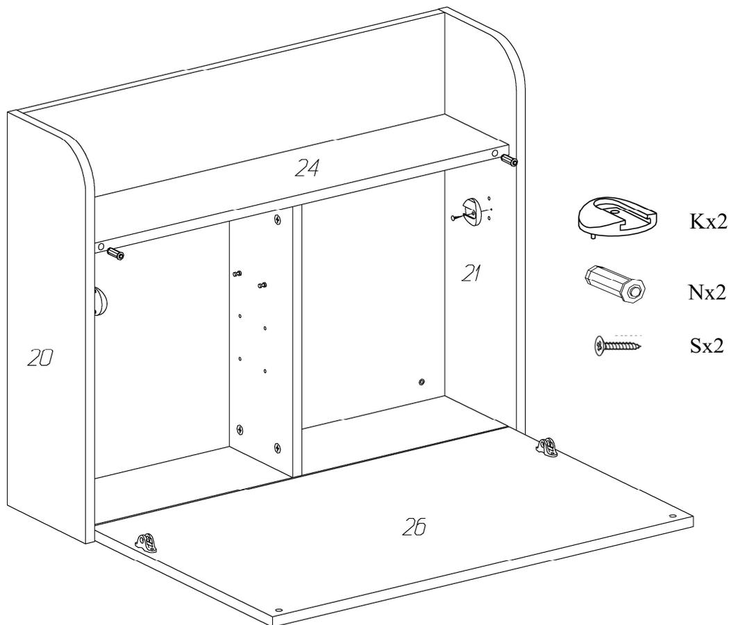
Крепление обязательно устанавливается пазом внутрь
